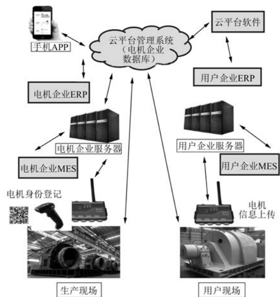
图4 电机远程运维系统架构图
