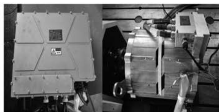
(a) 电机驱动器永磁同步电机试验平台
