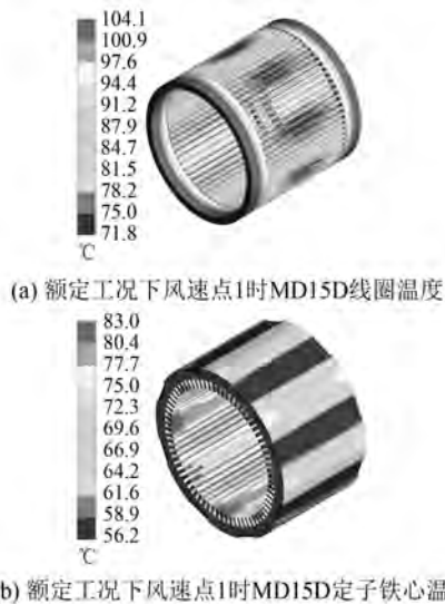
图9 基于热管的风冷 MD15D 电机额定工况下的温度分布
