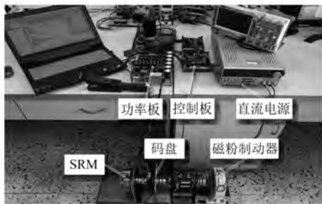
图7 控制系统试验平台
