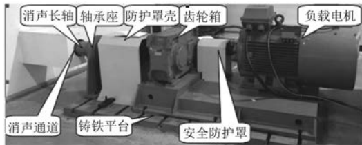
图 2 负载机械安装实物图
