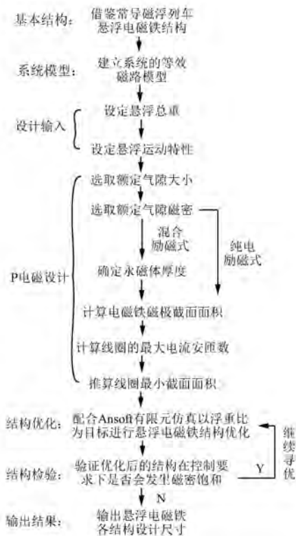
图 2 常导悬浮电磁铁的设计思路
