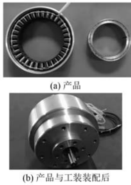
图2 F电机样机实物图(含测试工装)
