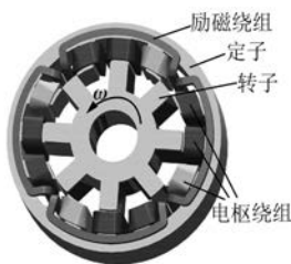
图2 12/8极DSEM结构图
