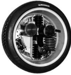
图1 米其林公司开发的内转子轮毂电机
