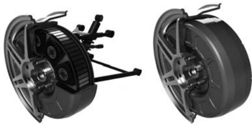
图2 Protean Electrics公司开发的外转子轮毂电机
