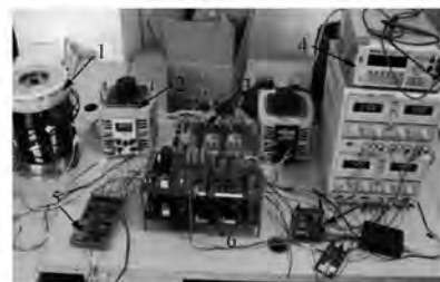
注: 1-电机本体 2-交流变压器 3-位移传感器 4-稳压电源 5-接口电路 6-功率模块 7-DSP 最小系统板
