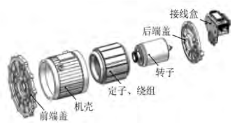
图 1 永磁同步电机三维模型
