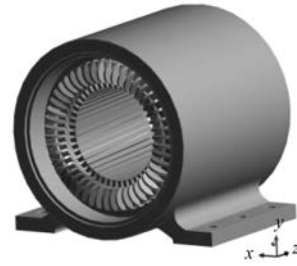
图2 电机定子系统
