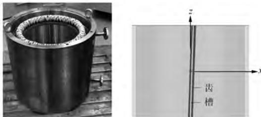
图1 定子及斜槽示意图
