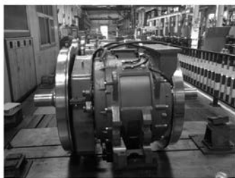
图 3 驱动跑合试验
