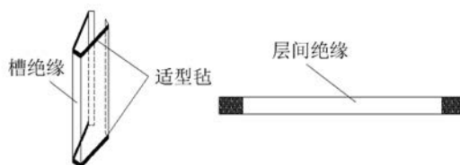
图 2 槽绝缘及层间绝缘两端粘贴适型毡示意图
