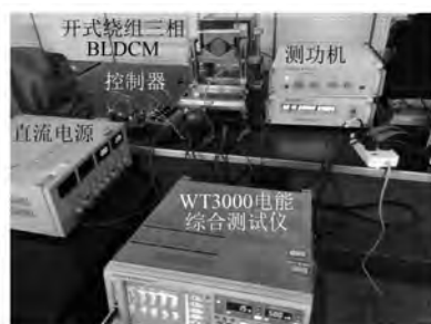
图 12 样机试验平台
