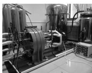
图 10 转子分段式高温超导励磁磁通切换电机及
