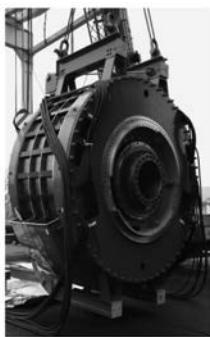
图 7 超导风力发电机 Ecoswing<sup>[17]</sup>
