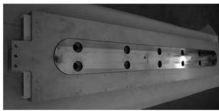
图 9 Ecoswing 高温超导绕组装配<sup>[17]</sup>
