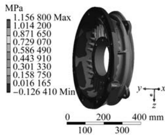
图 6 满载转矩法兰应力云图
