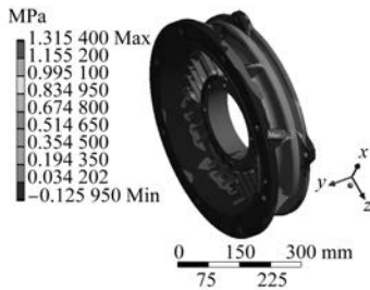
图 5 短路转矩法兰应力云图
