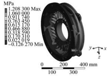
图 7 最大转矩法兰应力云图
