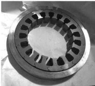
图 4 样机 SMC 定子铁心
