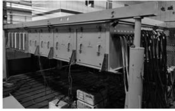
图 13 试验所用的四象限整流+牵引逆变一体变流器
