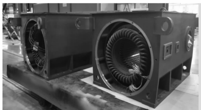
图4 定子线圈内挡风圈结构
