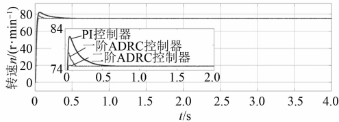
图 5 空载工况下电机的输出速度曲线
