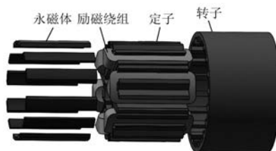
图1 永磁辅助开关磁阻电机三维结构
