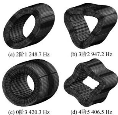
图 6 电机定子低阶模态振型
