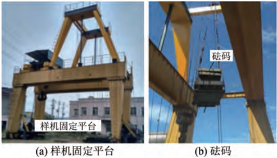
图 15 样机温升试验平台
