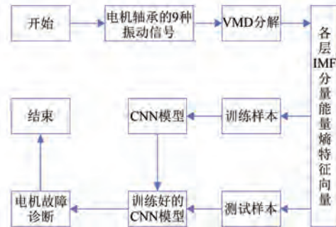
图 2 电机故障诊断流程图
