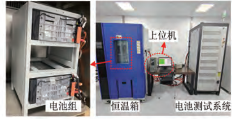
图4 电池测试试验平台
