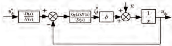
图 5 电压外环控制框图 Fig. 5 Control block diagram of voltage outer loop
