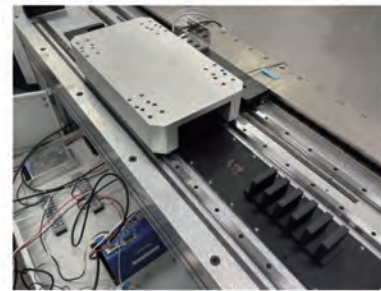
图 20 直线电机样机定位力测试平台实物图
