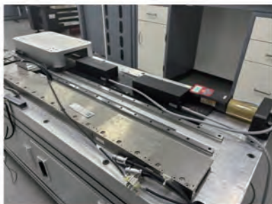
图 23 直线电机样机推力测试平台实物图
