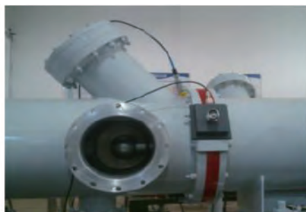
图 2 GIS 放电故障模拟试验装置
