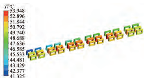
图 14 附加冷却系统后满载绕组温度分布
