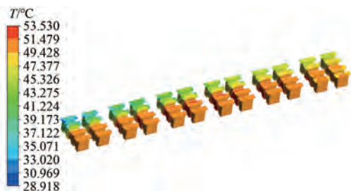
图 13 附加冷却系统后满载动子温度分布
