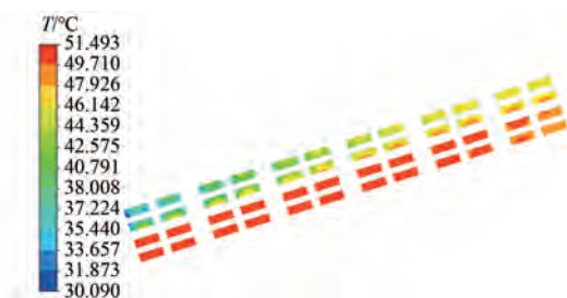
图 15 附加冷却系统后满载永磁体温度分布
