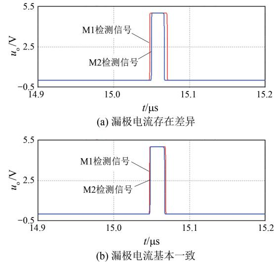
图 7 CMOS 非门电路输出电压
