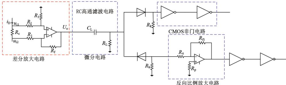
图4 电流检测电路
