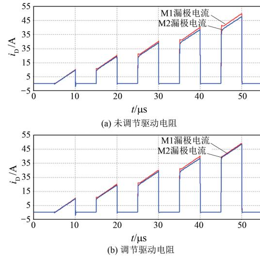
图 11 调节前后漏极电流对比 (800 V)
