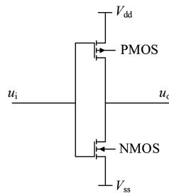
图 6 CMOS 非门电路
