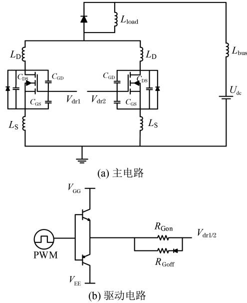
图 9 SiC MOSFET 并联测试电路
