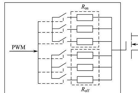
图 8 多级驱动电阻结构示意图
