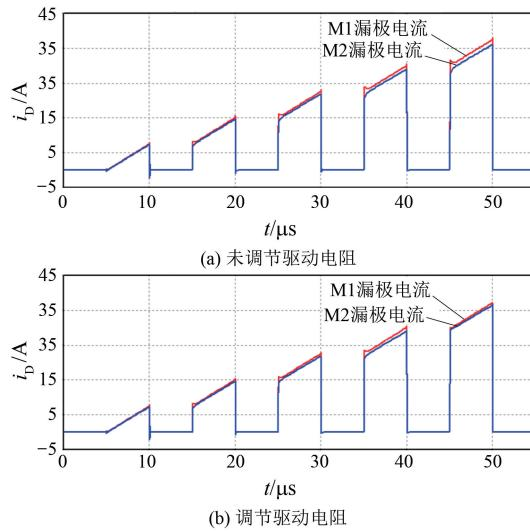
图 10 调节前后漏极电流对比 (600 V)
