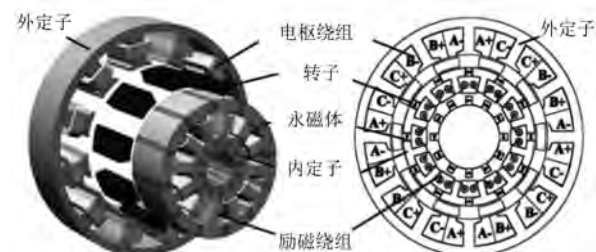
图 12 双定子混合励磁磁通切换电机
