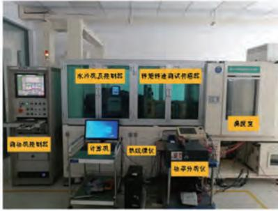
图 6 样机测试平台
