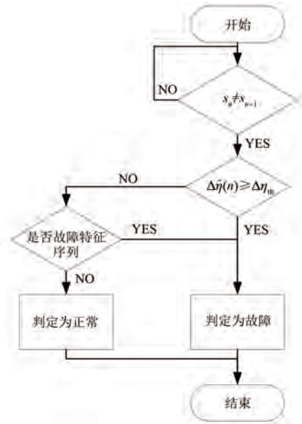
图5 新型快速故障诊断策略流程图
