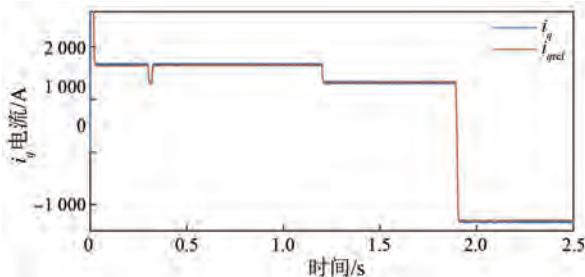
图 20 两机并联矢量控制系统在转矩扰动时的定子  $q$  轴电流波形图
