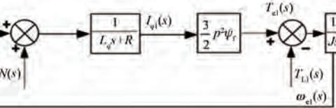
图 14 转速环简化控制流程图
