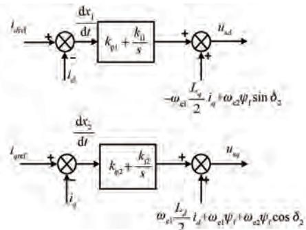
图 7 矢量控制的电流环控制框图
