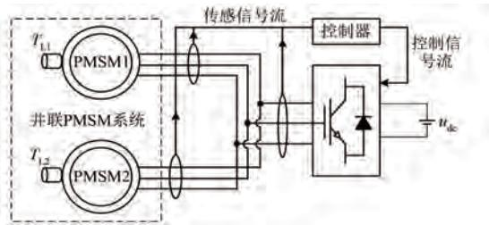
图3 单变流器多PMSM并联系统矢量控制结构
