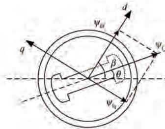
图 1  $d$ - $q$  坐标系下 PMSM 结构示意图
