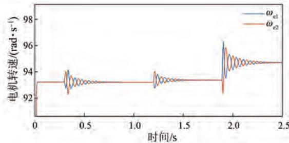
图 17 两机并联矢量控制系统在转矩扰动时的电机转速波形图
