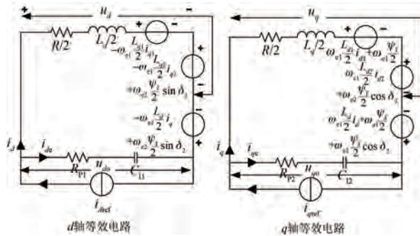
图 9 单变流器双 PMSM 并联系统等效电路
