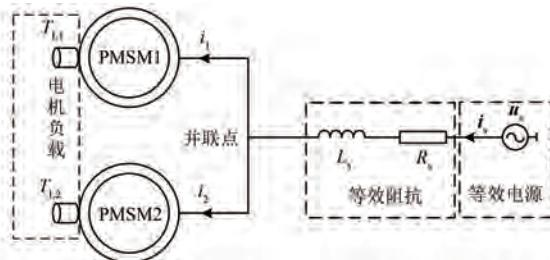
图 2 单变流器双 PMSM 并联系统拓扑结构
