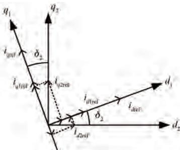
图 5 参考电流的坐标变换关系
