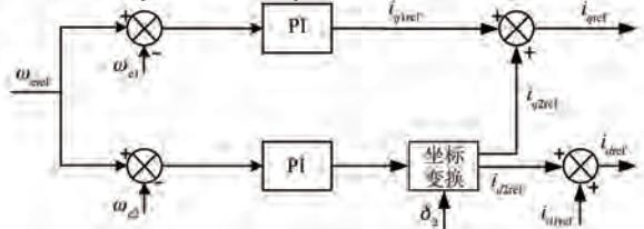
图 6 矢量控制的转速环控制框图
