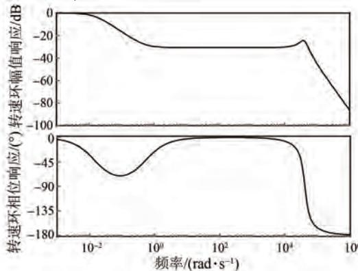
图 15 转速环开环传递函数伯德图
