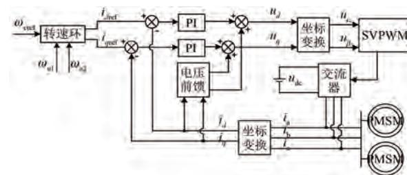
图4 基于转子磁链定向的多机矢量控制策略框图
