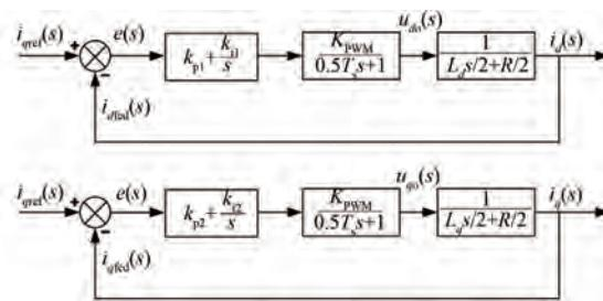
图 10 单变流器双 PMSM 并联矢量控制系统的  $d$ 、 $q$  轴电流环的控制流程图
