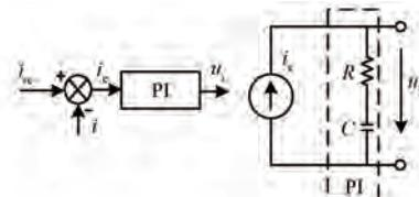
图 8 典型 PI 调节器和 RC 串联电路结构图
