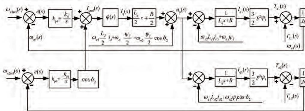
图 13 转速环控制流程图
