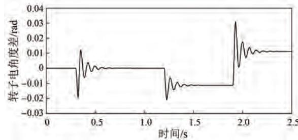
图 18 两机并联矢量控制系统电机在转矩扰动时的转子角位置差波形图
