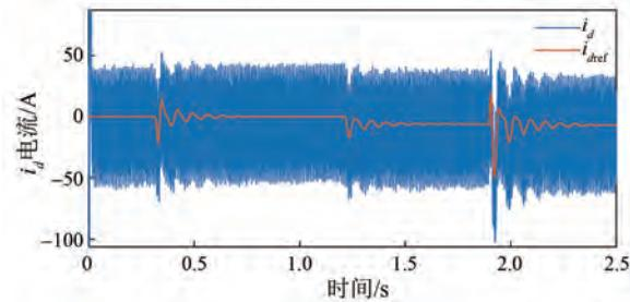
图 19 两机并联矢量控制系统在转矩扰动时的定子  $d$  轴电流波形图
