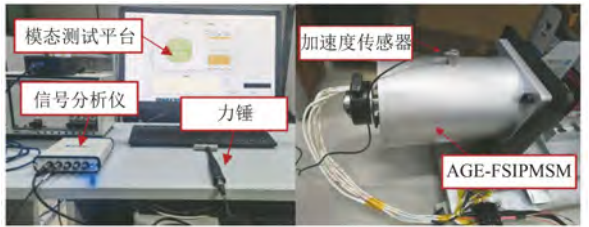
图6 模态试验平台 Fig.6 Modal test platform
