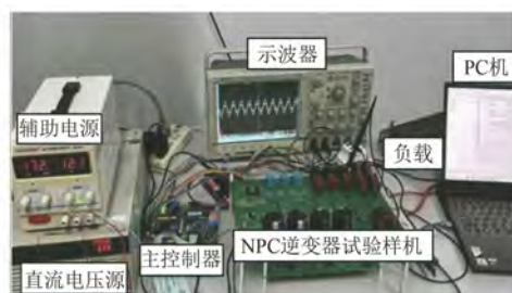
图 17 NPC 三电平逆变器试验平台
