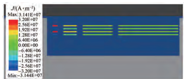
图7 优化后400 kHz下电流密度分布
