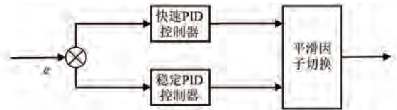
图6 切换控制结构图
