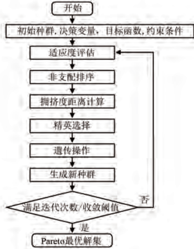
图 4 基于 MOGA 的谐波电流参数优化流程
