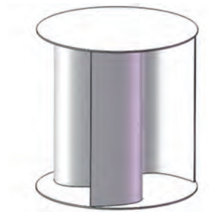
图 3 无扭度单叶片风机 Fig. 3 Torsionless single-blade fan
