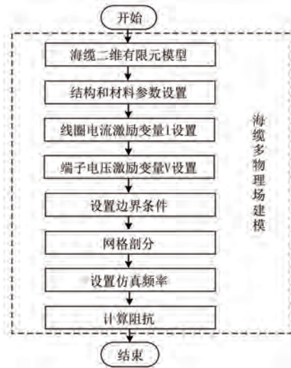
图 4 有限元海缆建模流程
