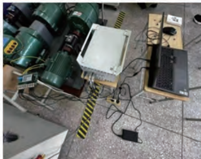
图 12 异步电机试验现场接线图
