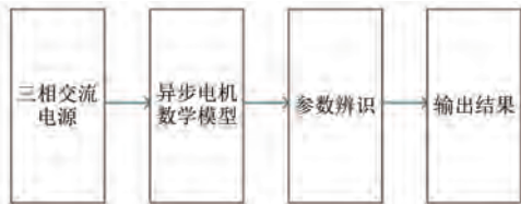
图 3 异步电机直接起动仿真流程
