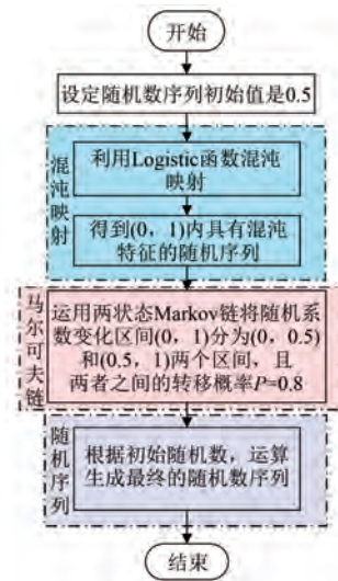
图 4 LM 随机数生成流程图
