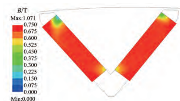
图 13 150 °C、两倍过载纯稀土电机磁密云图
