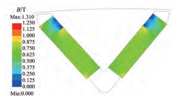
图 12 150 °C、两倍过载磁密云图
