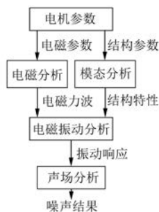
图 3 电机电磁振动噪声仿真流程
