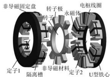
图 1 AFFSPM 电机三维结构图
