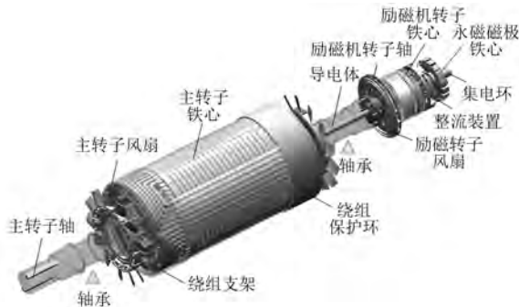
图 4 15MW-4P 汽轮发电机转子结构图
