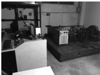
图 8 适配功率电机试验平台
