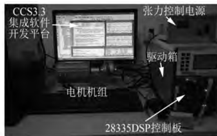
图6 永磁同步电机伺服系统试验装置
